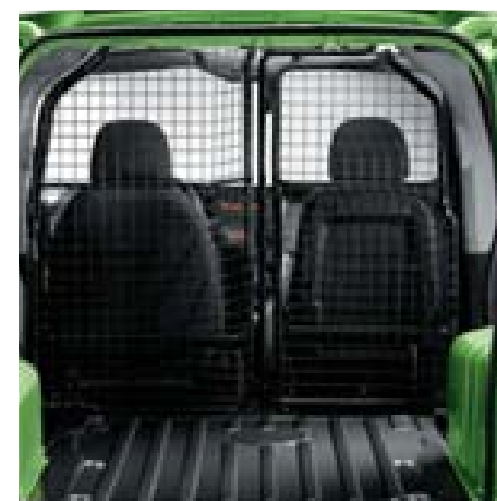
Zweiteilige Trennwand mit Schutzgitter: auf der Fahrerseite fest montiert, auf der Beifahrerseite beweglich, um so im Zusammenspiel mit dem umlegbaren Beifahrersitz die Ladefläche zu verlängern
